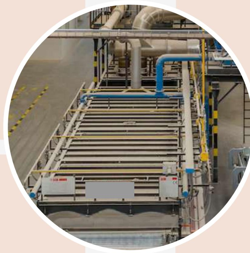
El calor residual de gas del horno se aprovecha en secadero boxes, ahorrando así el gas natural necesario
