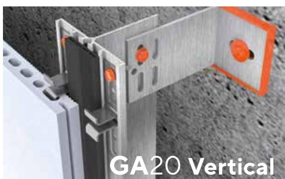
Sistema de fijación mediante perfiles verticales formado por ménsulas de retención y sustentación, clips simples y dobles de acero inoxidable y elementos de conexión. La junta vertical continua incorpora un perfil de EPDM para evitar la entrada de agua y las vibraciones. Las ménsulas están diseñadas para poder adaptarse a distintos espesores de cámara. Permite distancias de hasta 1200 mm de luz entre perfiles verticales y es compatible con **GA16**, **GA20** y **GA30**.
